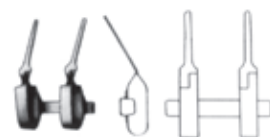
BIEMER-MÜLLER 45-115 Çene uzunluğu/Lenght of jaws.9 mm Açıklık/Opening 5 mm Kapanma kuvveti/Closing force 25-30 gr.
